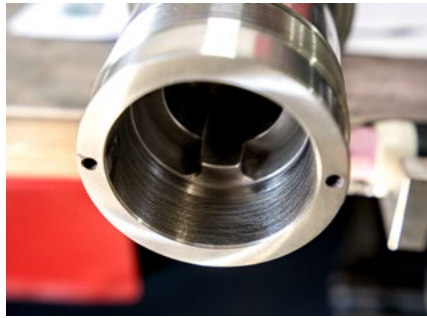
HSK 50 Konus mit hochfestem legiertem Draht, lasergeschweißt. Innenkonus vor Endbearbeitung
