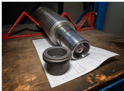
Die Schnittstelle wurde aus der Frässpindel ausgedreht. Die neue vorgefertigte Schnittstelle wird nun eingesetzt. Das Wellenrettungssystem vom Spindeldoctor
